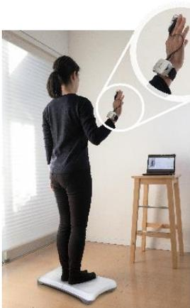
横浜国立大学等による研究成果に基づき、UNTRACKED が独自開発した転倒リスクの計測技術を用いた装置です。
