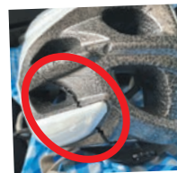
▲割れたヘルメット
