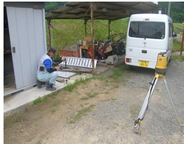
プリズム反射鏡と機械を操作するタブレットのみで測量業務を行うことが可能。作業員が測量地点まで移動すると、測量機も自動でプリズム反射鏡を追いかけるようにして次の測量地点の数値を算出する。
