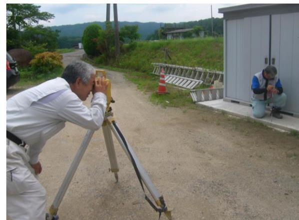
測量機器を操作する作業員とプリズム反射鏡をかざす作業員が必要だった。
