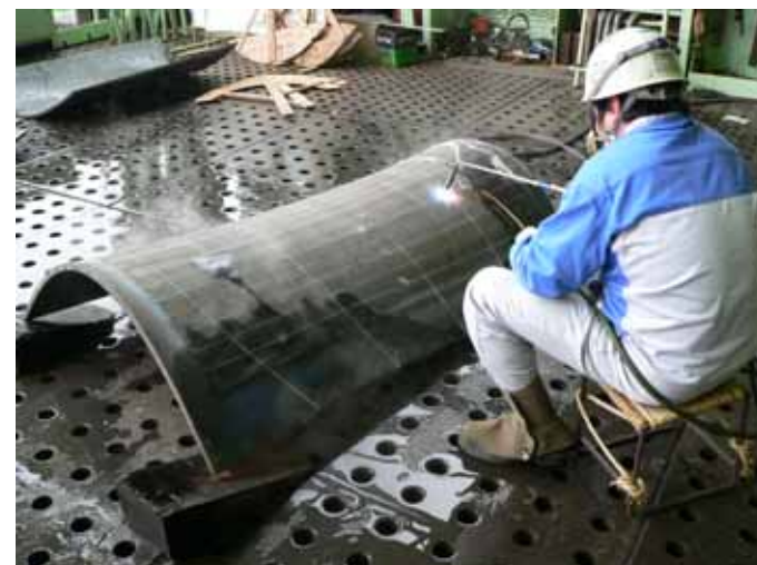
ガスバーナーと水によって曲げられてゆく鋼板（取材協力：尾道造船）
